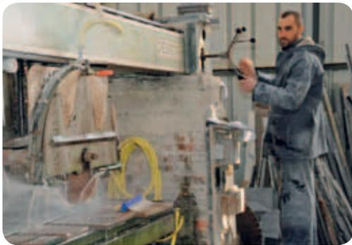
Des dalles sont découpées avec des pastilles diamantées refroidies par jets d'eau.
