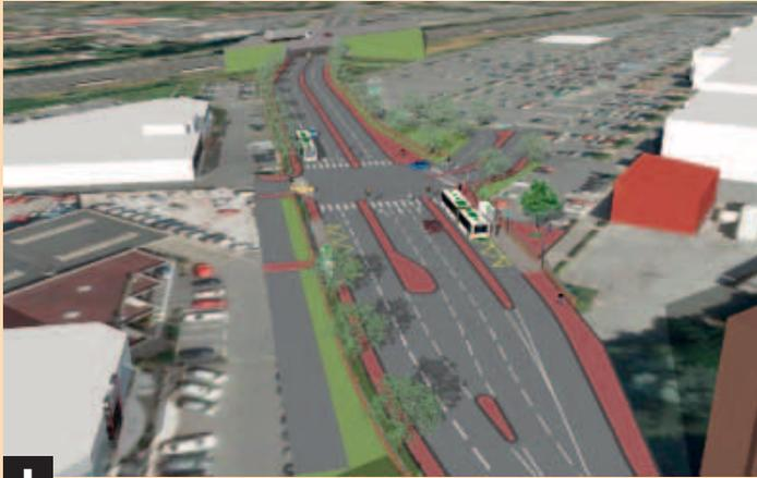
**1 Carrefour Boulevard d'Halluin/centre commercial :** aménagement de couloirs de bus latéraux de 3,50 mètres de large partagés avec les deux roues, refonte complète de l'entrée du centre commercial par un carrefour à feux qui va gérer d'un côté l'accès à Auchan et de l'autre les accès aux concessionnaires, au Carré des Halles, à la boulangerie Louise. Arrêts de bus transférés à Roncq en vis-à-vis aux abords de ce carrefour réaménagé.
